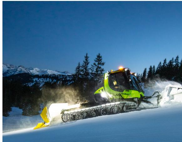
Kässbohrers Pistenbully 600E+ mit elektrischem Antrieb
